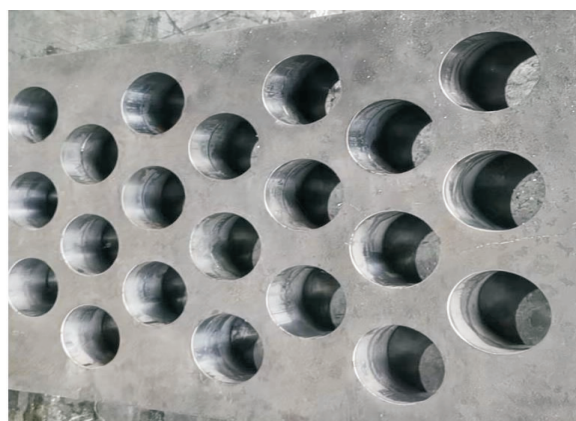
图6 龙门镗铣床先钻再镗孔实物图
